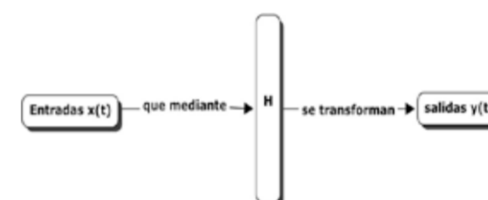
Figura 1. Estructura general de un sistema.
